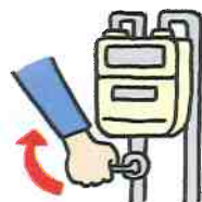
ガスメーターバルブ
